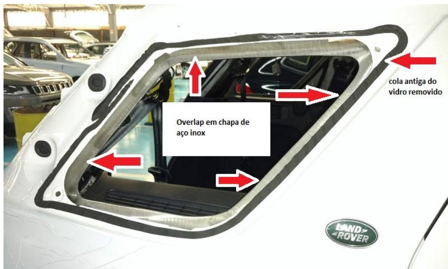
Figura 3 - Exemplo de overlap nos quadros dos vidros fixos
